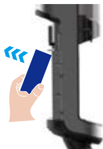
7. Załóż gumowe rękawice i wyjmij baterię.
