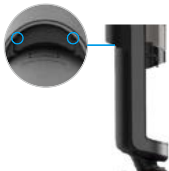
4. Odkręć wkrętakiem krzyżakowym dwie śruby na tylnym panelu urządzenia.
